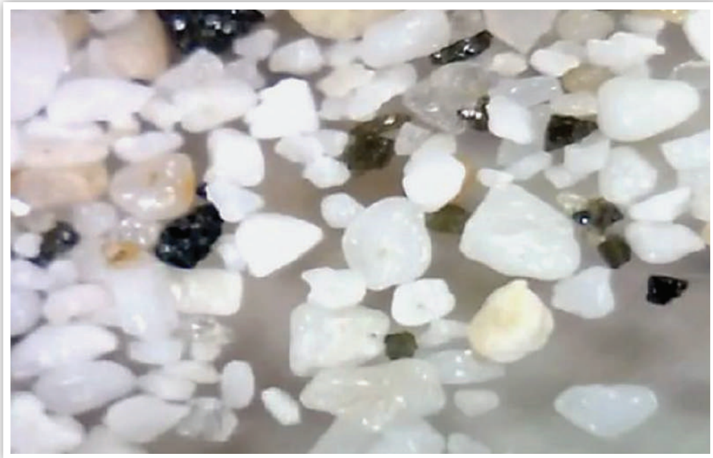
Foto 4.28 Bentuk butiran pasir yang runcing-runcing ( angulars ) hasil perbesaran mikroskopis (Sudjtmiko, 2012)
